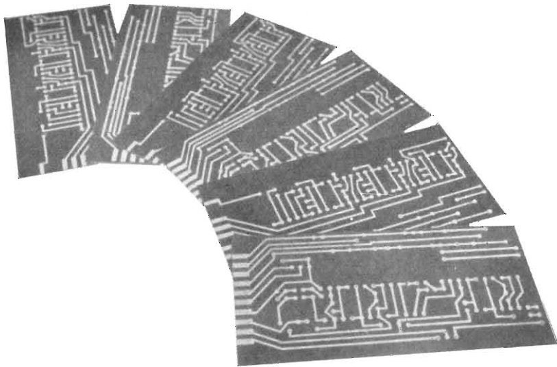
Esempi di pannelli recanti circuiti stampati, adatti per la realizzazione di circuiti elementari del tipo illustrato nella pagina di fianco.
