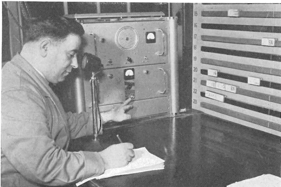
I radiotelefonisti sono entrati in uso anche nei centri ferroviari di smistamento. Ecco un centralino dal quale vengono spostate, secondo le necessità, le locomotive di uno scalo merci inglese.
