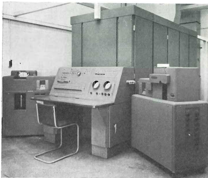
La foto rappresenta la macchina calcolatrice aritmetica usata nel National Physical Laboratory di Teddington, nei pressi di Londra, e nota con il nome di DEUCE. Essa è impiegata in particolar modo nello studio dei problemi associati con il volo dei missili, la navigazione aerea e navale mediante radar, lo studio delle tensioni nei materiali. La DEUCE fu costruita, alcuni anni or sono, dalla English Electric Company Ltd.
